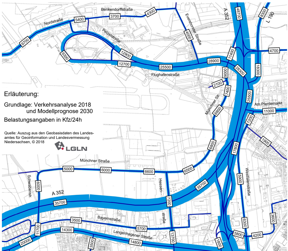
Bild 7: Prognosebelastungen im Planfall mit Sondergebiet Multifuel-Autohof
